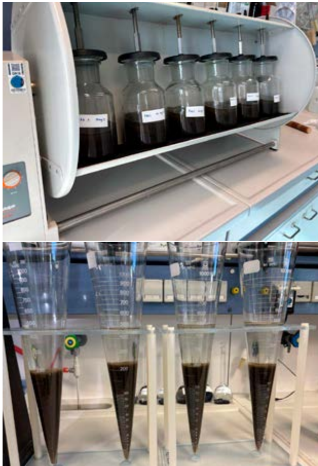
Bild 11.4: Laborversuche zur Eignungsprüfung von Pulveraktivkohlen Fig. 11.4: Laboratory tests to assess the suitability of powdered activated carbons
