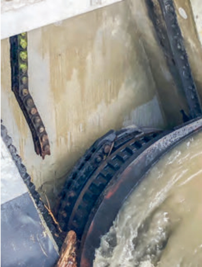
Bild 17.2: Gerissene Kette der Wehrwalze des Wasserkraftwerks Halingen (WWW) Fig. 17.2: Torn chain of the drum of the hydropower station Halingen (WWW)
