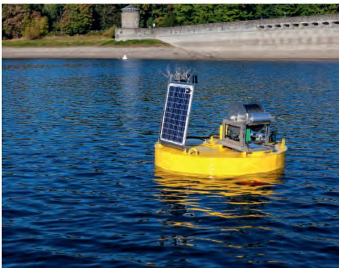
Bild 8.3: Messboje mit Einrichtungen zur Stromversorgung und Messwerterfassung vor der Staumauer der Möhnetalsperre
