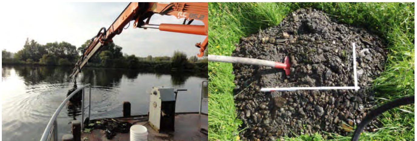
Bild 8.3: Greifer-Probenahme vom Boot (links), Sedimentprobe (rechts) Fig. 8.3: Gripper sampling per boat (left), sediment sample (right)
